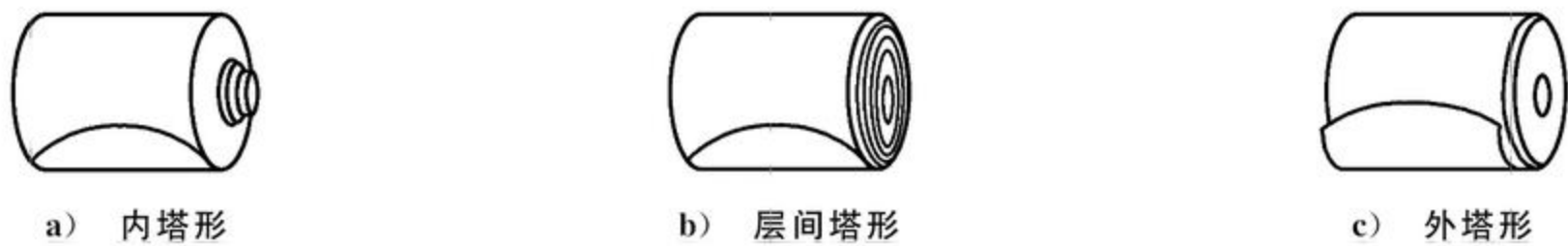
图 1 常见钢带的塔形形貌
